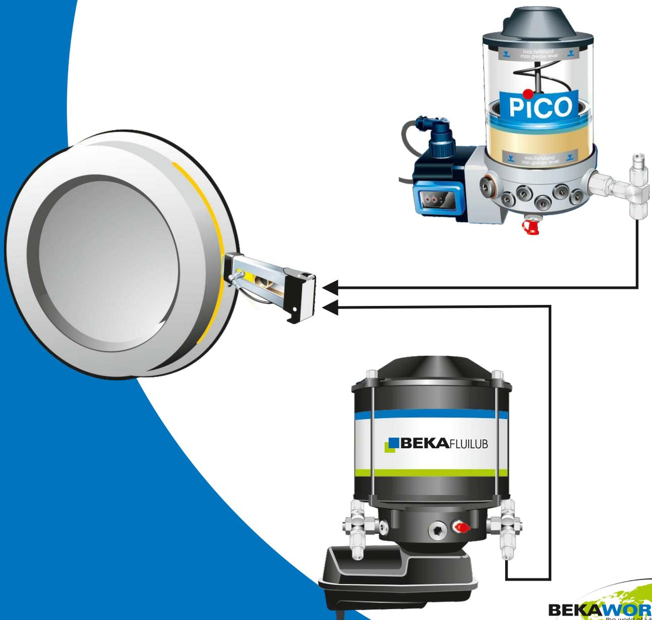
**FluiLub Spurkranzschmieranlagen reduzieren wirkungsvoll den Verschleiß von Schiene und Rad sowie die Geräuschbelastung in Kurven. FluiLub Spurkranzschmieranlagen bieten dem Anwender innovative Technologie mit bewährten Komponenten bei optimalem Kosten-Nutzen-Verhältnis.**
